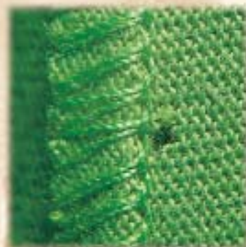
Daños en las mallas en tejido de punto
